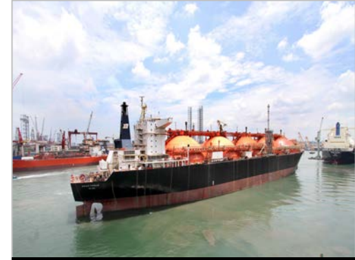
FSRU Golar Freeze, Golar LNG
